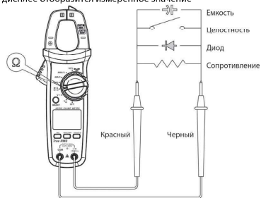
Рис. 4 Проверка целостности, измерение сопротивления, проверка диода, измерение ёмкости
